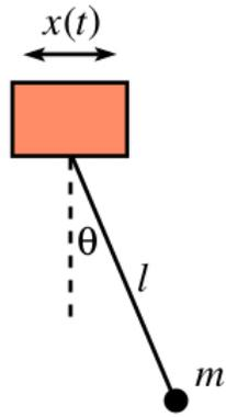
Figura 1: Configuración del péndulo en el problema 1.
