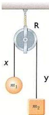
*Figura 1: Máquina de Atwood con polea de radio  $R$ . Se denota por  $x$  la distancia vertical entre  $m_1$  y el centro de la rueda. Nótese que  $L$  es la suma de tres términos.*
