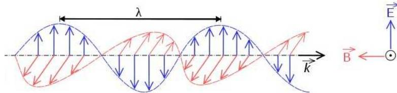
Figura 5: Esquema de onda electromagnética.
